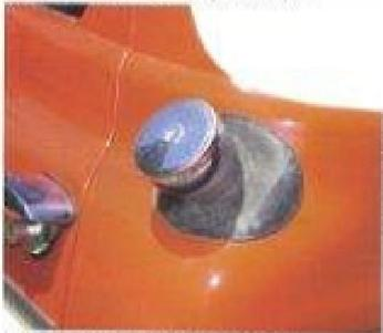
Bocal de reabastecimento na coluna do lado esquerdo. Tampa com chave da Nôrma só na Luxo.
