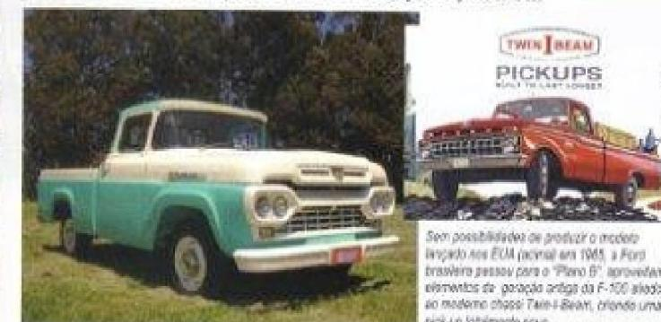
Sem possibilidades de produzir o modelo lançado nos EUA inicial em 1965, a Ford brasileira passou para o "Plano B", aproveitando elementos da geração antiga da F-100 aliados ao moderno chassis Twin-I-Beam, criando uma picape totalmente nova.
