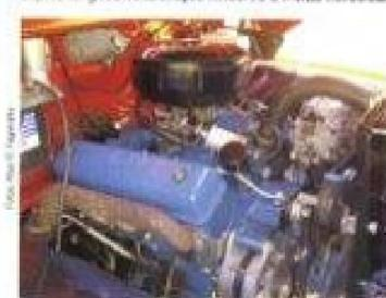
Sob o capô, o Ford "Power-King" V8, de 4.498 cm³ de cilindrada, ou 272 pol., idêntico ao das versões anteriores da F-100, com potência de 165hp.
