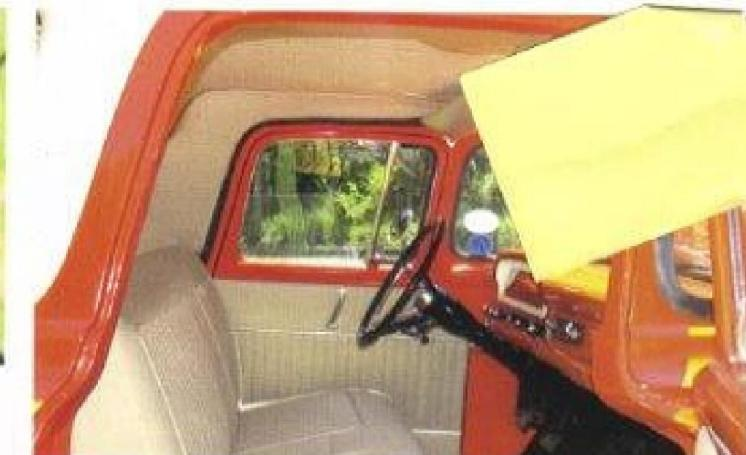
No Twin-I-Beam Luxo, o banco combinava revestimentos em vinil liso, com costuras diferenciadas nas áreas de contato do corpo do motorista e passageiro. O painel em couro era pintado na cor do veículo.
